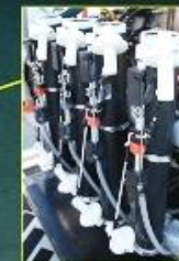
CTD of sensores: * fluorescência * clorofila * O 2 * CO 2
